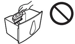
否則浮體無法偵測水位狀況，從而導致漏水，並可能損壞周圍的物品或引起觸電和（或）漏電事故。
