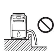
水管浸在水中。 水管高於排水口。
