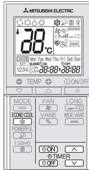
**1** Tryk på under afkølingsdrift (COOL), økonomiafkølingsdrift (ECONO COOL) eller opvarmningsdrift (HEAT) for at vælge i-save-drift.
