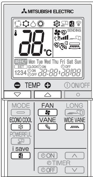
1 Pulse **i save** durante el modo REFRIGERACIÓN, DESCONEXIÓN AUTOMÁTICA o CALEFACCIÓN para seleccionar el modo i-save.
