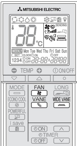
Pulse **FAN** para seleccionar la velocidad del ventilador. La velocidad del ventilador cambia con cada pulsación en el orden siguiente:
