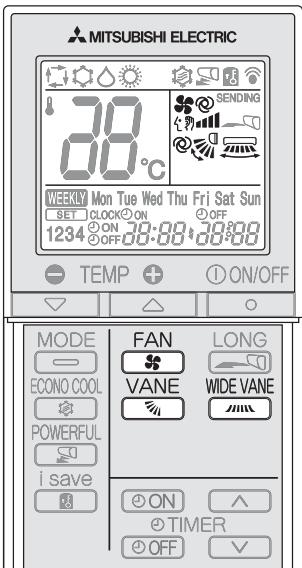
Нажмите **FAN**, чтобы выбрать скорость вентилятора. При каждом нажатии скорость вентилятора изменяется в следующем порядке:
