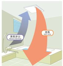
入浴後,只需採用「温 風乾燥」模式(温風 + 換氣),即可迅速消除濕 氣和令人討厭的霉味, 也有助抑制長靏和結露。
